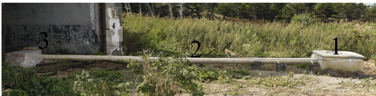
Рисунок 2.10 – Поверхностный лазерный деформограф на м. Свободный о. Сахалин. 1 – интерференционный узел, 2 – лучевод, 3 – уголкового отражатель.
